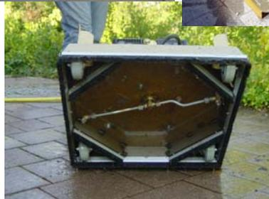
Ein Rotationsarm mit 2 Sprühdüsen dicht über der Oberfläche bewirkt die intensive Reinigung
