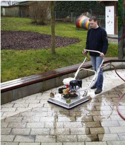
Das Easy-Clean EC 60 reinigt Oberfläche und Fuge gleichzeitig, das Spritzwasser wird von einer Abdeckhaube zurückgehalten
