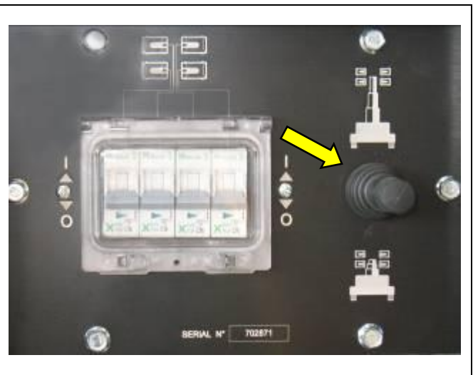
Abbildung 5.6 – Ausfahren des Masts
