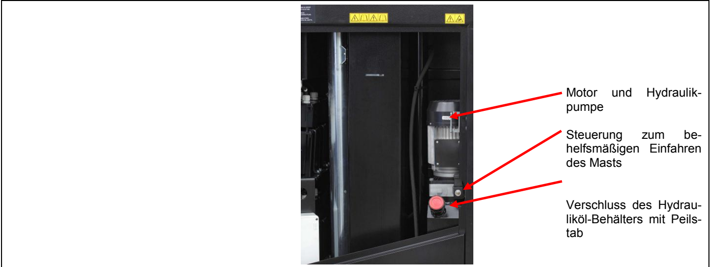
Abbildung 2.2 – Lage von Schalttafel, Bedienfeld und Hydraulik-Einheit
