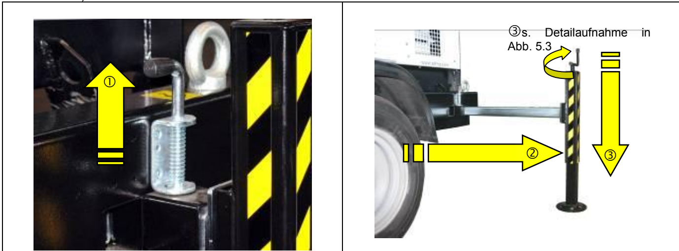
Abbildung 5.2 – Ausfahren der Stützen
