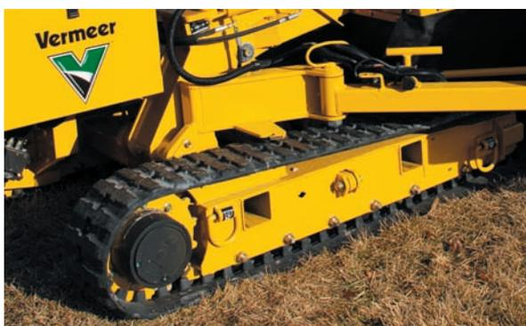
**Kein Wenderadius.** Das Planetengetriebe sorgt für eine bessere Traktion, während die gegendrehenden Raupenlaufwerke das Manövrieren unter schwierigen Einsatzbedingungen ermöglichen.
