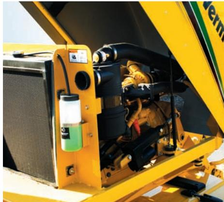
Die SC60TX ist mit einem **wassergekühlten 44.74 kW (60 PS) Diesel-Motor ausgestattet**, der stets für optimale Leistung sorgt.
